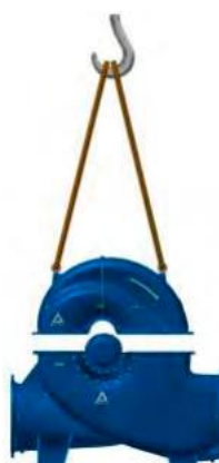
Способ подъёма при установке и демонтаже верхней крышки насоса
