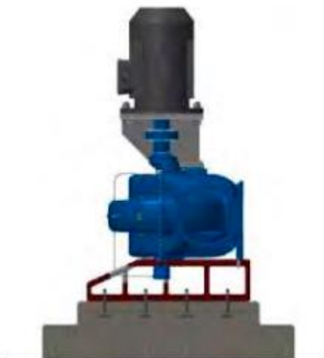
Случай прямого привода насоса от двигателя
